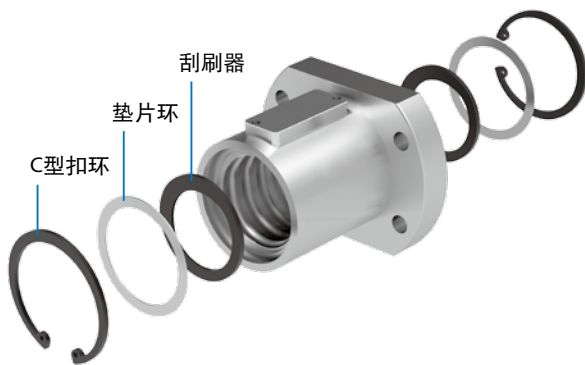
图47. 橡胶油封刮刷器
